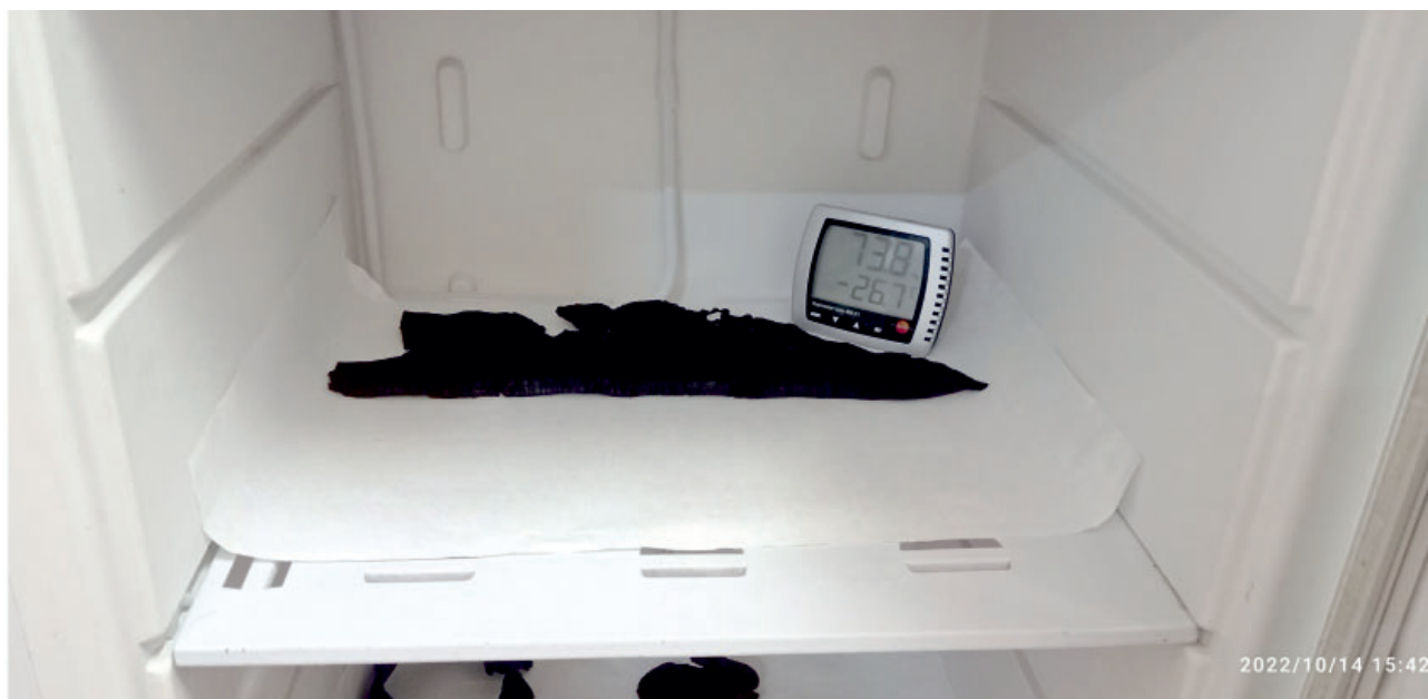
Рис. 3. Сублимационная сушка в бытовой морозильной камере.
