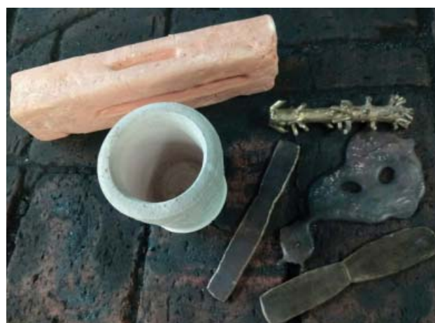
Рис. 5. Реплика формы, тигель и металлическое сырье (эксперимент Д.А. Меренкова) Fig. 5. Cast replica, crucible and metal raw material (D.A. Merenkov's experiment)
