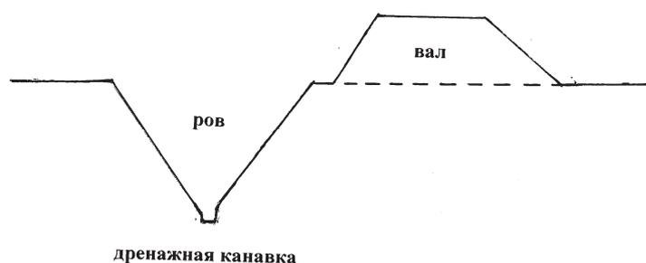
Рис. 3. Вал и ров с дренажной канавкой.
