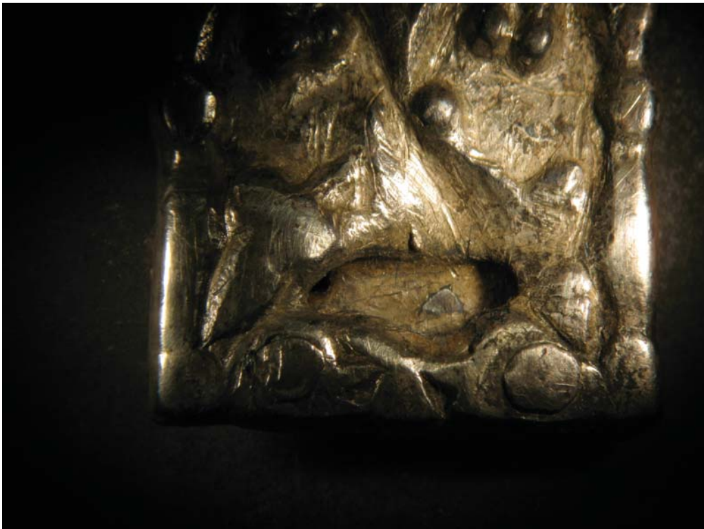
Рис.11: 2. Следы зачистки литейного шва и литейных дефектов на рамке пряжки
