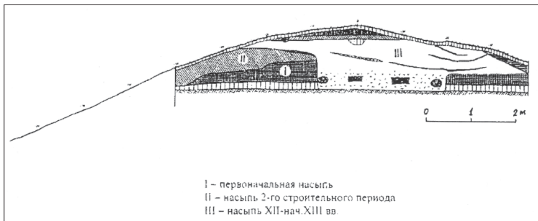
Рис. 83. Суварское городище. Профиль оборонительной линии
