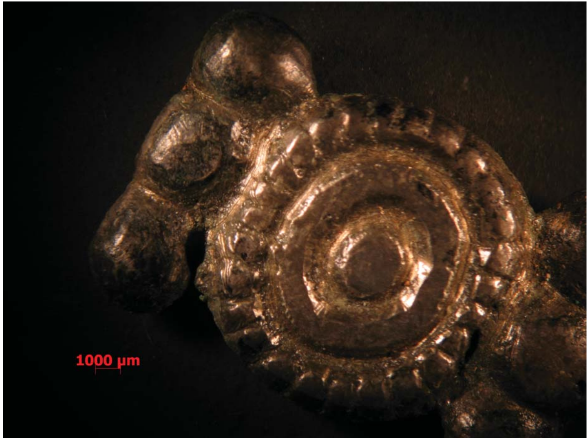
Рис. 5:2 Литейные дефекты и следы абразивной обработки на лицевой поверхности накладки головного убора
