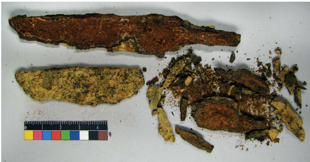
Рис .2. Образование порошкового акаганеита на металлическом ядре железного ножа через год после раскопок. Фото С.Г. Буршневой.
