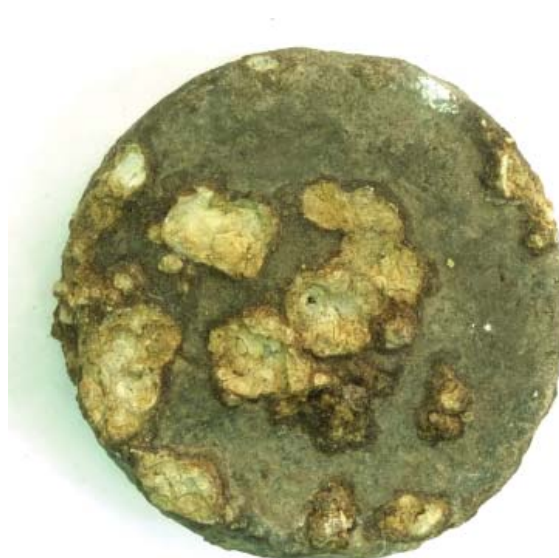
Рис. 4. Коррозионные язвы на поверхности свинцового грузила, сформировавшиеся в погребенных условиях и заполненные порошковыми продуктами коррозии свинца. Фото П.В. Федана.
