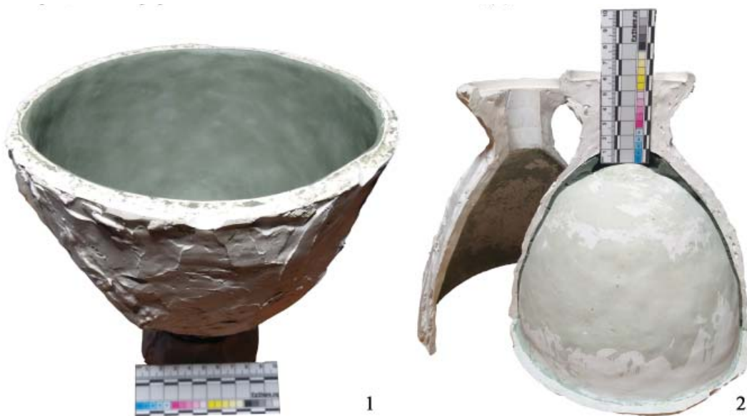
Рис.7 Процесс изготовления основы для сосуда №56. (1) Заливка шликера (2) Удаление глины Fig.7 The process of making the base for vessel No. 56. (1) Pouring liquid clay (2) Removing clay
