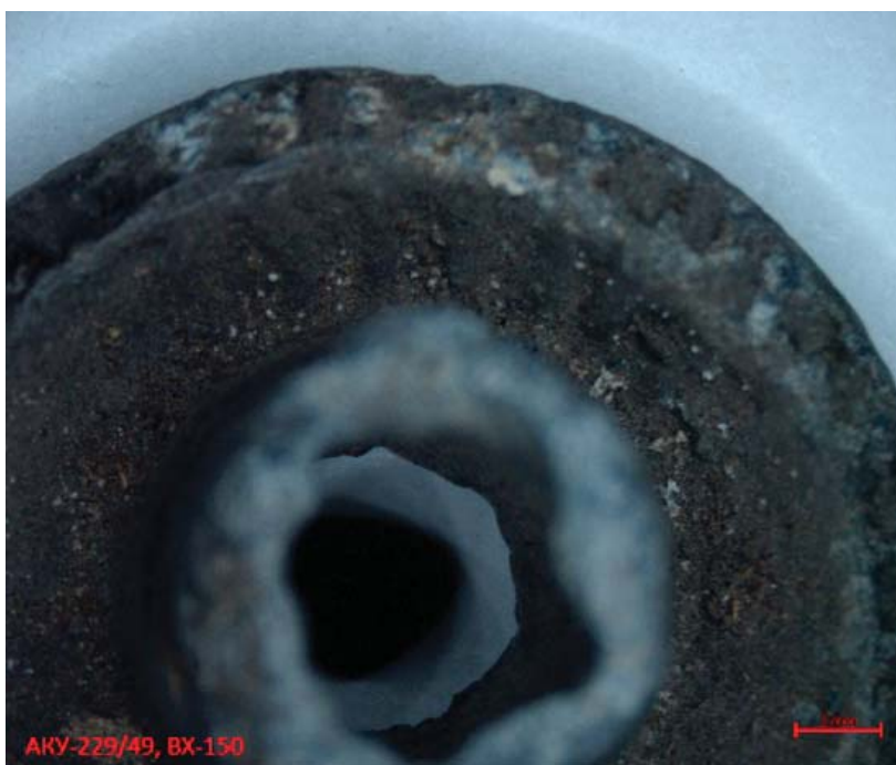
Рис.6. Признаки активной коррозии на поверхности свинцовой пломбы. Макросъемка, микроскоп Zeiss Stemi 305 ув. 10х3. Фото А.Р. Нуретдиновой.
