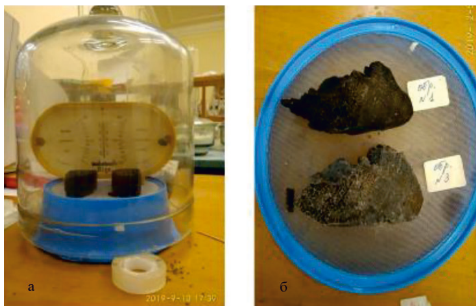
Рис. 3. Сушка пропитанных консолидантом образцов древесины: а – «мягкая» сушка с контролем влажности воздушной среды под стеклянным колпаком ( W_{\text{воздуха}} = 60-90\% ); б – досушка в температурно-влажностных условиях лаборатории
