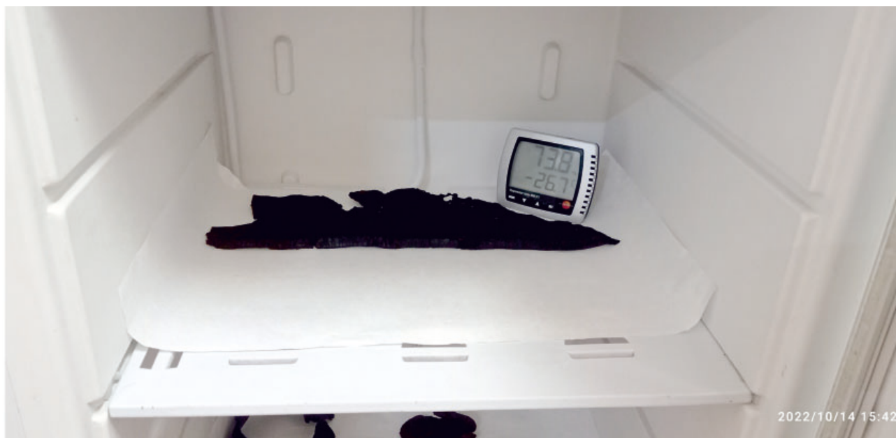
Рис. 3. Сублимационная сушка в бытовой морозильной камере.
