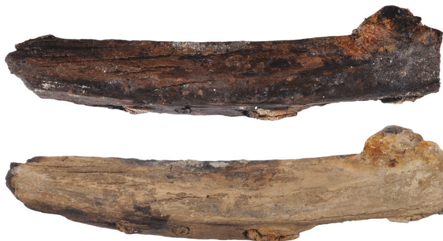
Fig. 10. Image of a group of timbers belonging to the Yenikapı 36 shipwreck after conservation with Kauramin 800. Рис. 10. Рисунок древесины, принадлежащей затонувшему судну Yenikapı 36, после консервации с применением Kauramin 800.
