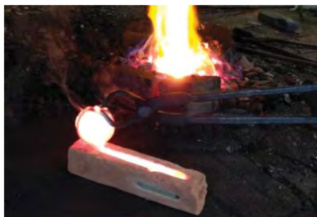
Рис. 6. Процесс отливки слитков (эксперимент Д.А. Меренкова) Fig. 6. Ingot casting process (D.A. Merenkov's experiment)
